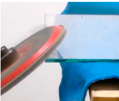
EL CANTO LIJADO EN ARISTA, REALIZADO MANUALMENTE O CON MÁQUINA, NO ELIMINA LAS MICROFISURAS.
